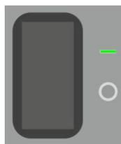
5.1 Включить сетевой выключатель на модуле источника питания контроллера. На лицевой панели источника питания должен включиться индикатор "+24 V", должна начаться инициализация центрального процессора и модулей контроллера.
