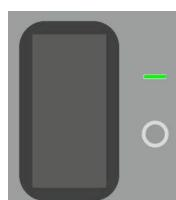
4.5.2.1 Включить сетевой выключатель на модуле источника питания контроллера. На лицевой панели источника питания должен светиться индикатор "+24 V", должна начаться инициализация центрального процессора и модулей контроллера.
