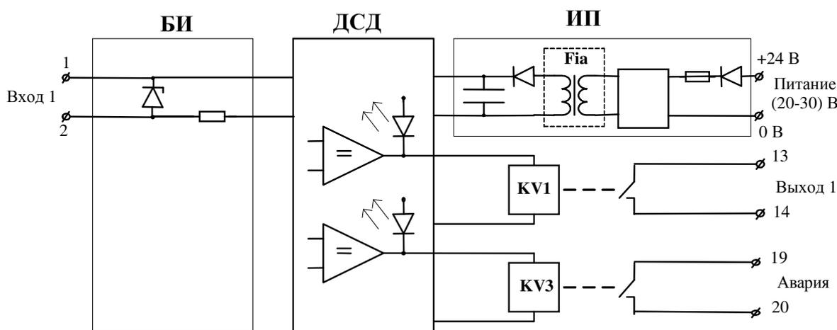
Рисунок 1 – Структурная схема преобразователя ET 121
