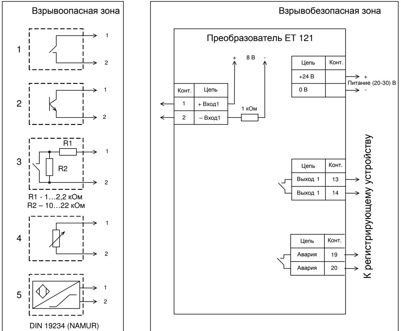
Рисунок В.1 – Схема подключения преобразователя ET 121
