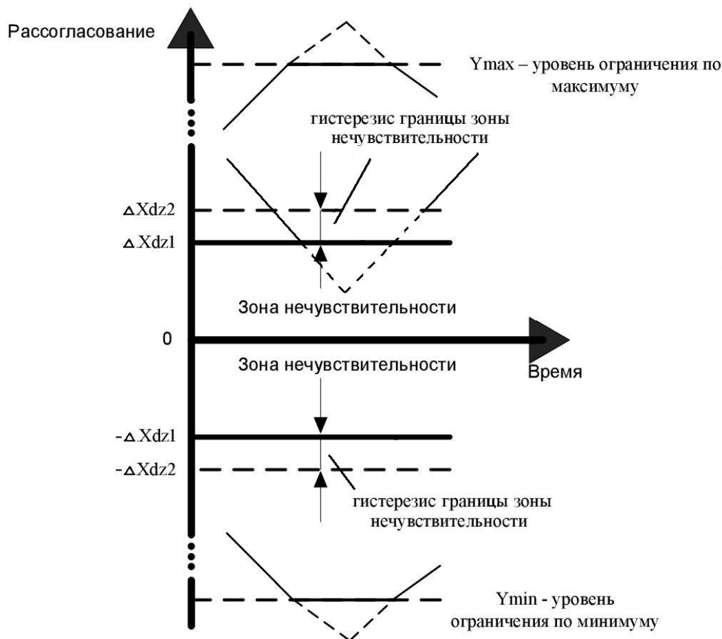
Рисунок 2 – Реализация в зоне нечувствительности и ограничения выходного значения ПИД-регулятора
