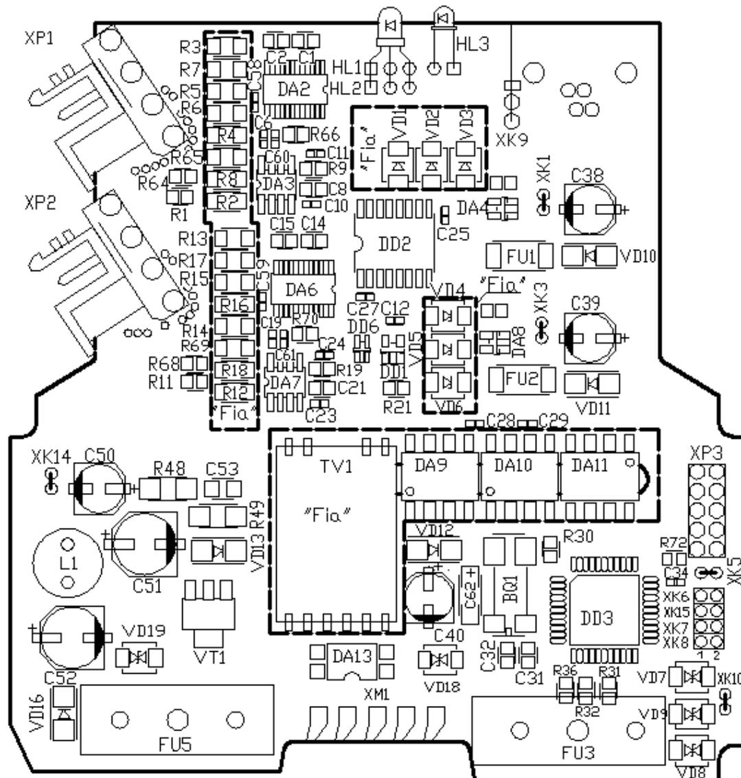
Рисунок Б.1 – Схема размещения элементов на плате ЕТ 382
