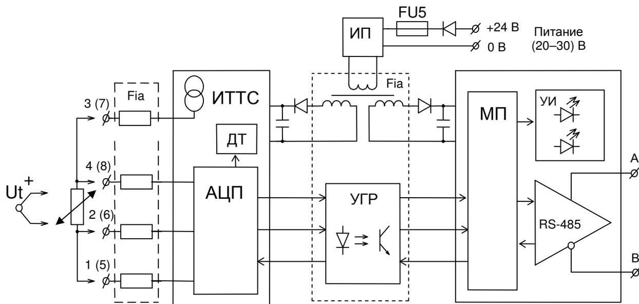
**Рисунок 1 – Структурная схема преобразователя ET 382**
