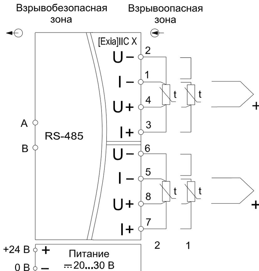
1 – трехпроводная схема
