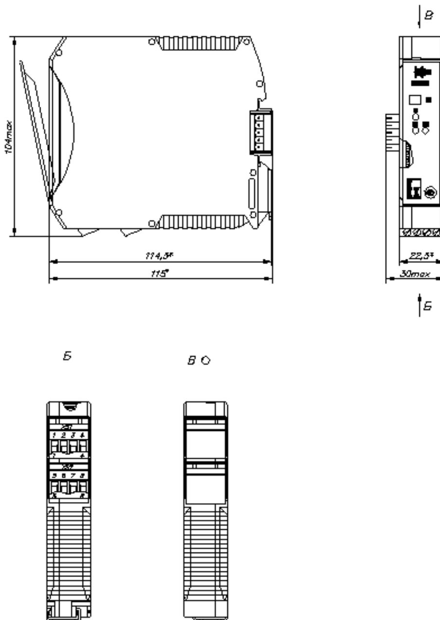
Рисунок А.1 – Габаритный чертеж преобразователя ET 382
