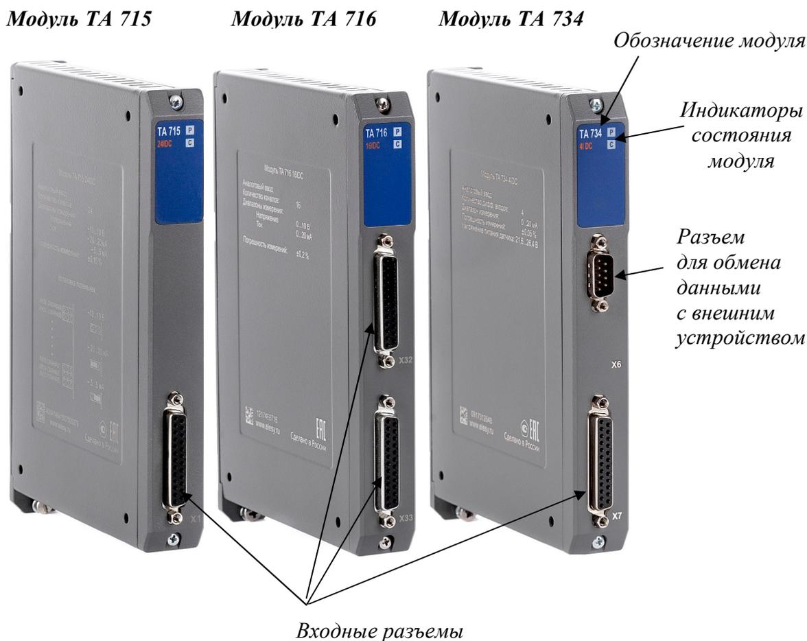
Рисунок 2.44 – Внешний вид модулей аналогового ввода
